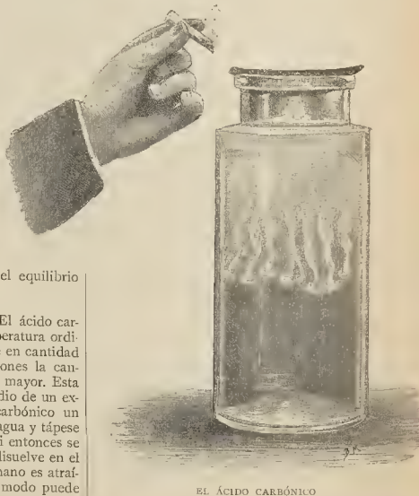
Fig. 2. El humo de un cigarro sobre una capa de ácido carbónico
